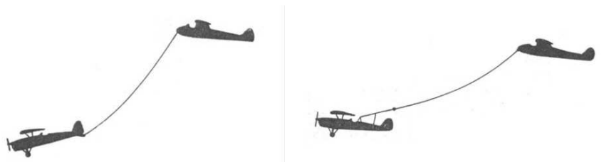
Zachowanie zespołu przy wysokim wyjściu szybowca ponad samolot holujący dla różnego umiejscowienia zaczepu w samolocie
